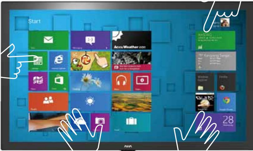
정전용량 터치방식은 대화면에 적합한 Metal Mesh 방식의 정전용량 터치패널로서 필름에 도전성 패턴을 형성한 전극을 종횡으로 배치한 강화유리에 손가락 또는 도전성 펜이 닿으면 인체의 정전용량이 회로에 추가되고, 변화한 용량을 감지해서 터치 위치를 검출하는 원리입니다.
